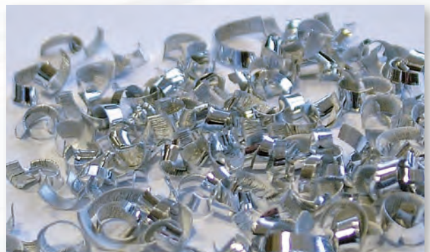
Mit 3D Chip-Breaker: Bruchspäne
