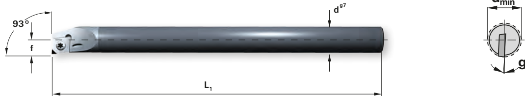
Abb.: Ausführung rechts Bohrstange, Ausführung rechts, mit zylindrischem Hartmetallschaft und innerer Kühlmittelzufuhr
