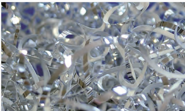
Ohne 3D Chip-Breaker: Fließspäne
