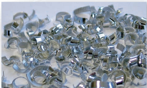
S 3D utvařečem třísky: odlamovaná tříska
