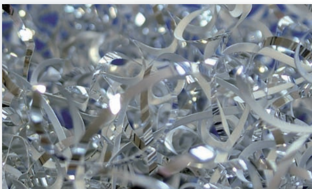
Bez 3D utvařeče třísky: dlouhá tříska
